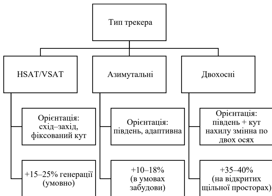
Рис. 1. Взаємозв'язок типу трекера, орієнтації та рівня генерації енергії
